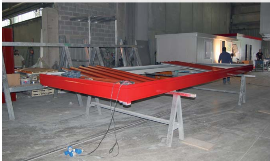
NEGLI SPAZI ORGANIZZATI DELLO STABILIMENTO HA LUOGO IL PROCESSO PRODUTTIVO. I profilati vengono saldati da manodopera specializzata. Il profilo perimetrale del tetto dopo la verniciatura e l'essiccazione, che avviene in appositi forni.
